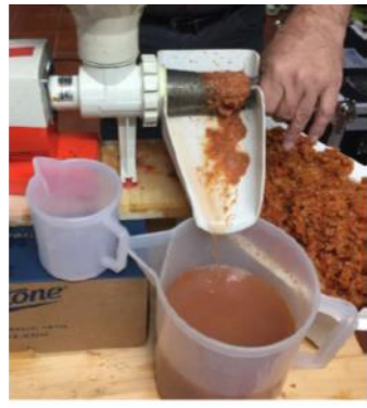
Separazione solido-liquido con separatore centrifugo
